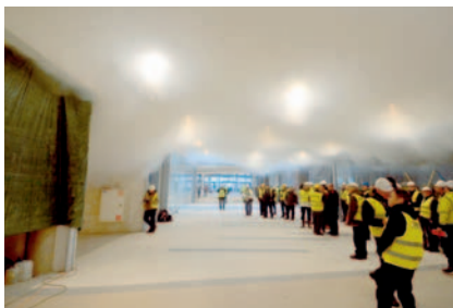
■ ■ Fot. 2. Wypływ dymu z przestrzeni lokalu oraz wytworzenie się podsufitowej warstwy dymu w czasie próby w pasażu handlowym wyposażonym w instalację tryskaczową
