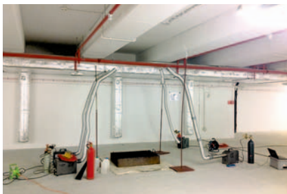
■ ■ Fot. 1. Przykład stanowiska do wytwarzania ciepłego dymu w czasie próby w garażu podziemnym wyposażonym w instalację tryskaczową
