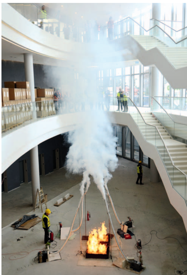
Fot. 10. Próba w przestrzeni atrium centrum kongresowego (oddymianie mechaniczne)
