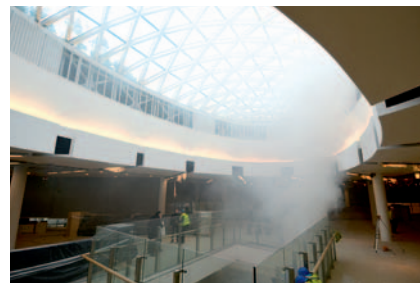
■ ■ Fot. 3. Widok kaskady dymu wpływającego do odrymianego świetlika w pasażu handlowym
